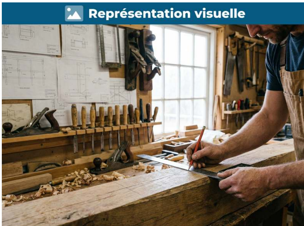
Traçage précis de la médiatrice pour un assemblage symétrique sur 600 mm
