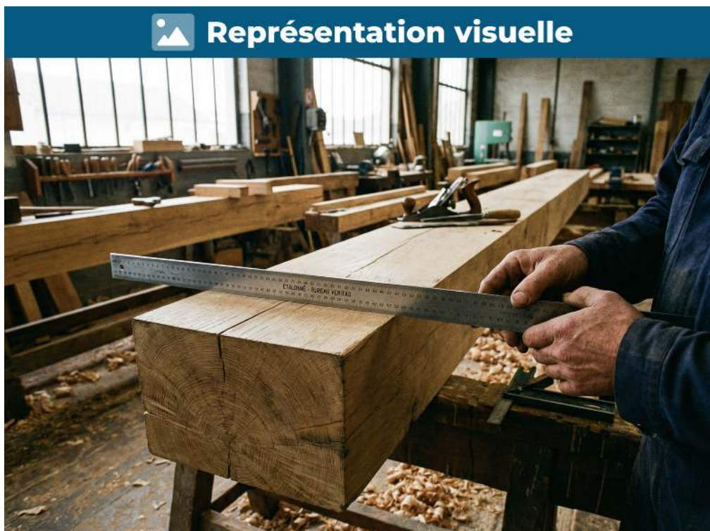
Mesurer avec précision, tolérance de \pm 2 mm pour les charpentiers de marine
