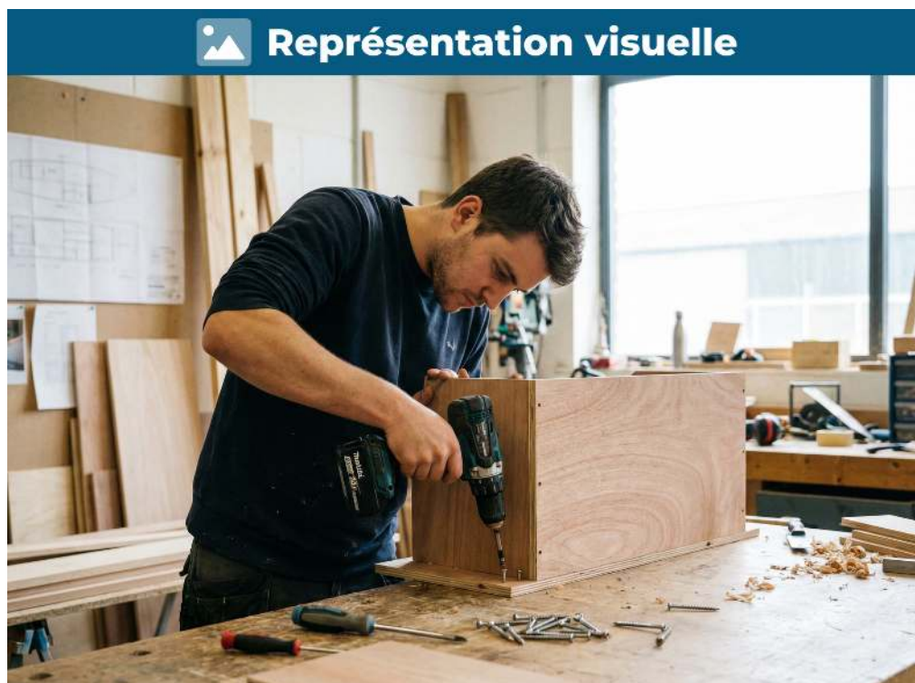
Assemblage étanche: collage époxy et vissage tous les 150 mm pour solidité.
